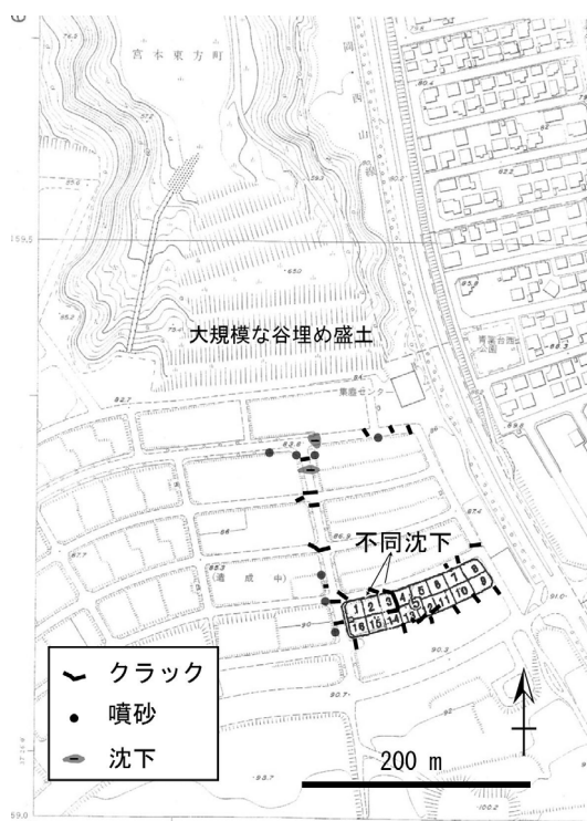
図-8 長岡ニュータウン（陽光台）における液状化被害
